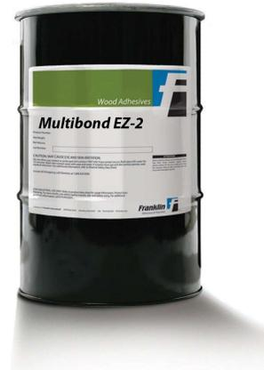
**Multibond EZ-2** es un adhesivo de emulsión de acetato de polivinilo de entrecruzamiento de un componente desarrollado con una temperatura mínima de uso baja para ser utilizado en una amplia variedad de condiciones de planta. Multibond EZ-2 cumple DIN EN204 D3 así como ASTM D-5572 de uso seco en uniones finger en listones de madera no estructurales.
